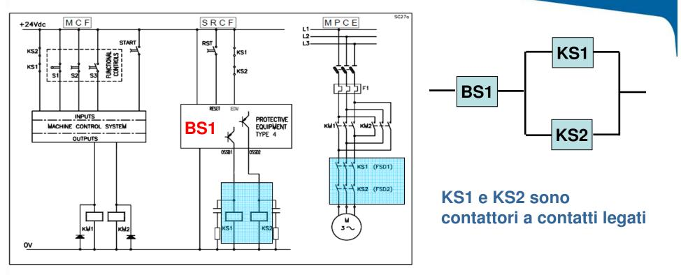
Il possibile cortocircuito fra i cavi che collegano gli OSSD a KS1 e KS2 deve essere evitato tramite appropriato layout oppure BS1 deve essere in grado di controllarlo
