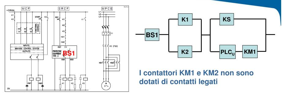
La struttura formata da KS, PLC<sub>II</sub>, KM1, è ridondante ma non completamente monitorata( il modulo di uscita del PLC non è monitorato, non tutti i guasti di KM1 vengono rilevati).
