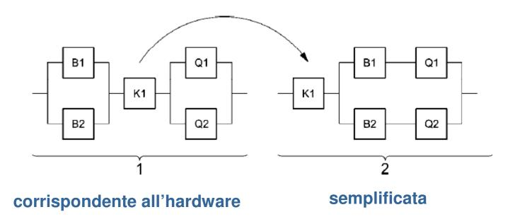
La sequenza dei sottosistemi è in linea di principio intercambiabile.
