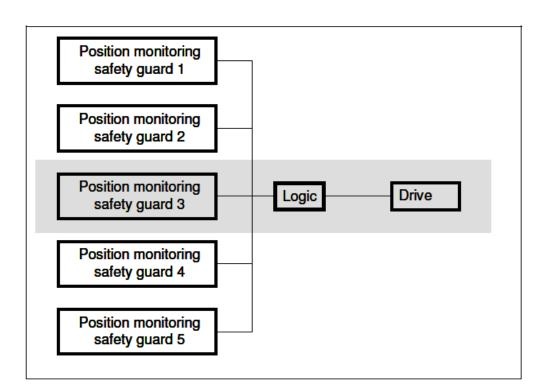
Le funzioni di sicurezza da calcolare sono 5 perché ogni cancello, preso singolarmente, garantisce la protezione
