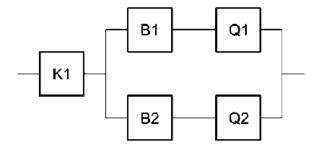
si ottiene infine sommando 2,47 x 10<sup>-8</sup> al valore PFHd del modulo K1
