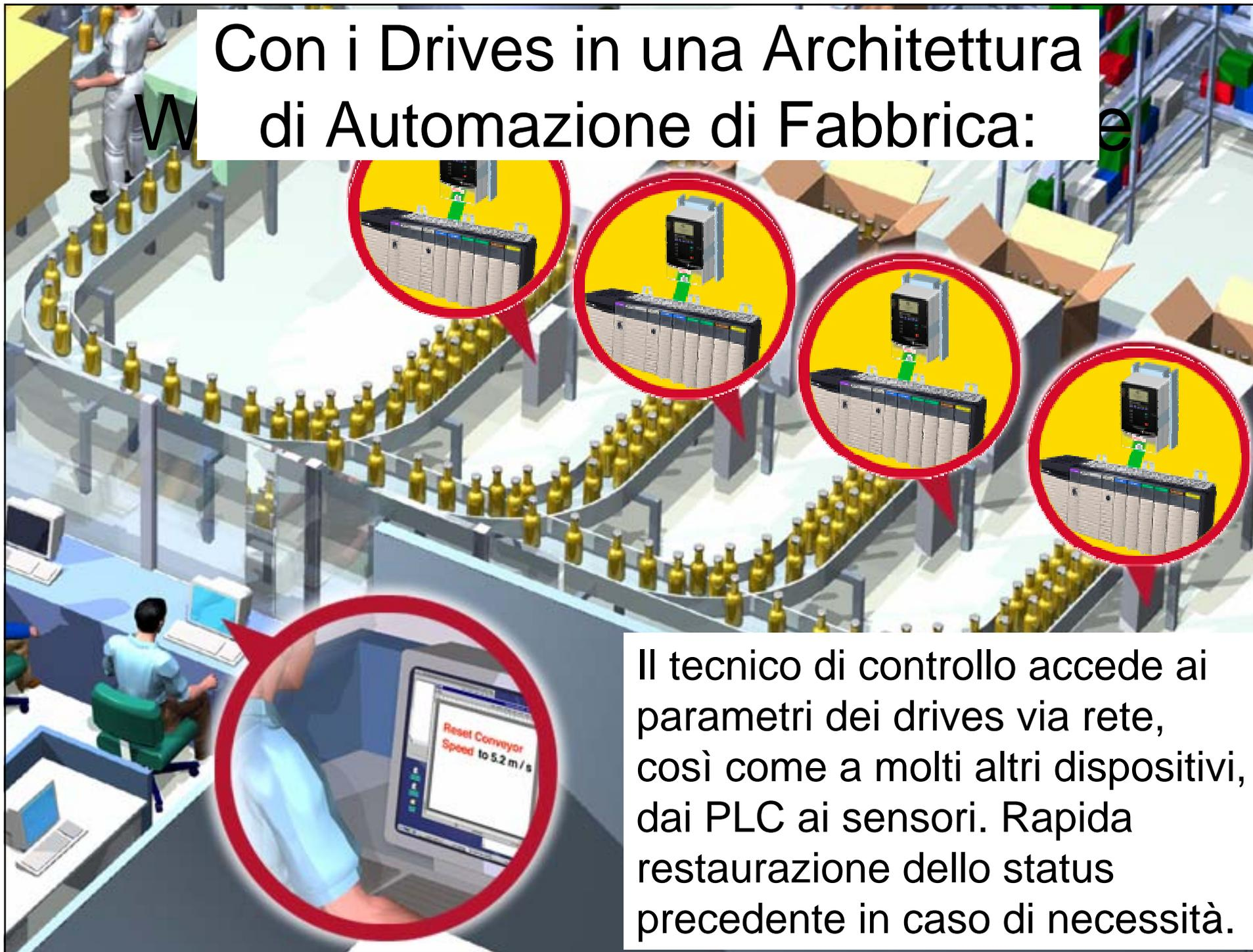
Il tecnico di controllo accede ai parametri dei drives via rete, così come a molti altri dispositivi, dai PLC ai sensori. Rapida restaurazione dello status precedente in caso di necessità.
