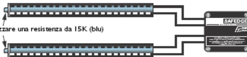
Possono essere connessi in parallelo al massimo due profili.
