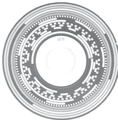
Figura 10 - Disco con codice Gray e tracce incrementali esterne
