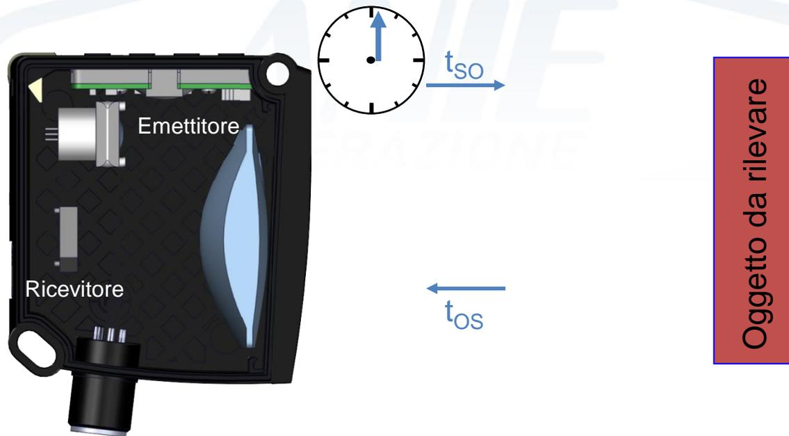
Deviando la direzione dell'impulso laser in un piano, grazie ad uno specchio rotante con passo angolare noto, è possibile effettuare misure in un piano, come avviene nei Lidar (o laser scanner) 2D
